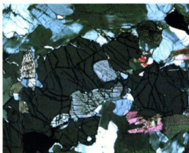
Диагностика образца гранито-гнейса проводилась в лабораториях института по общепринятым методикам визуально и на специальных приборах. Из спила образца изготовлен прозрачный петрографический шлиф (пластинка толщиной 0.03 – 0.05 мм) для исследования под микроскопом строения и минерального состава камня.
