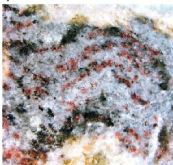
Блок гранито-гнейса является фрагментом прямоугольного параллелепипеда с двумя полированными гранями, размер блока 78 × 67 × 60 мм.
