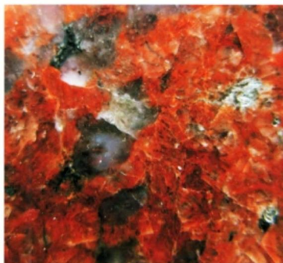
Блок гранита является фрагментом прямоугольного параллелепипеда с двумя полированными гранями, размер блока 78 × 65 × 35 мм.
