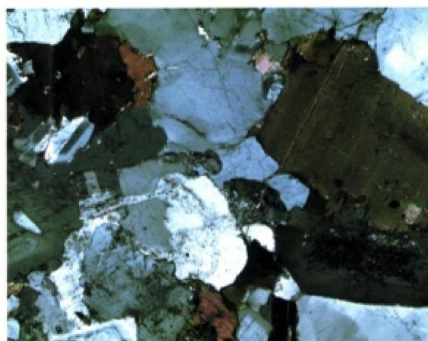
Диагностика образца гранита проводилась в лабораториях института по общепринятым методикам визуально и на специальных приборах. Из спила образца изготовлен прозрачный петрографический шлиф (пластинка толщиной 0.03 – 0.05 мм) для исследования под микроскопом строения и минерального состава камня.
