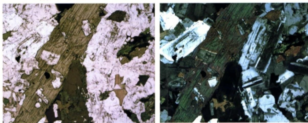
Диагностика образца габбро производилась в лабораториях института по общепринятым методикам визуально и на специальных приборах. Из спила образца изготовлен прозрачный петрографический шлиф (пластинка толщиной 0.03 – 0.05 мм) для исследования под микроскопом строения и минерального состава камня.
